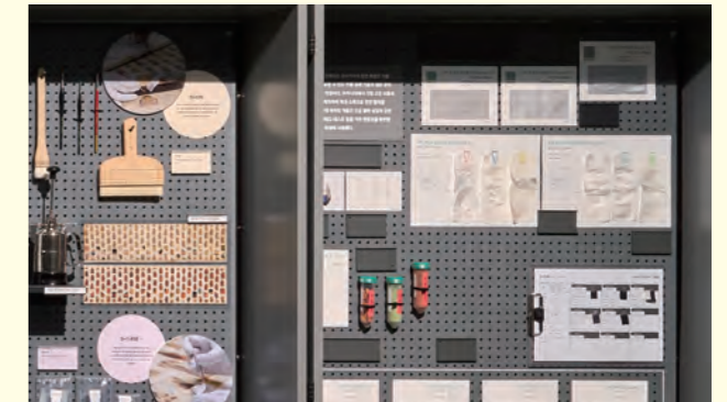
<자수가사>의 원형은 '명주 짜기'와 '천연 염색' 같은 전통 공예 기술과 더불어, 박물관 환경 조건에 맞는 극한의 인장 강도 계산, 내후성 시험기 안에서 진행된 '인공 열화'를 통해 복원했다. 뽕잎을 먹고 자란 국산 누에고치에서 가장 가늘고 고운 실을 찾기까지 1년, <자수가사> 복원과 실험에 필요한 명주 2-3필을 얻기 위해 또 여덟 계절의 기다림이 있었다. (왼쪽) 서울공예박물관 전시실과 온라인 채널을 통해 공개한 보존처리 현장 스케치 영상. (오른쪽) 보존처리 중 염색과 열화 과정을 보여 주는 자료가 전시돼 있다. 사진 제공: 서울공예박물관.
